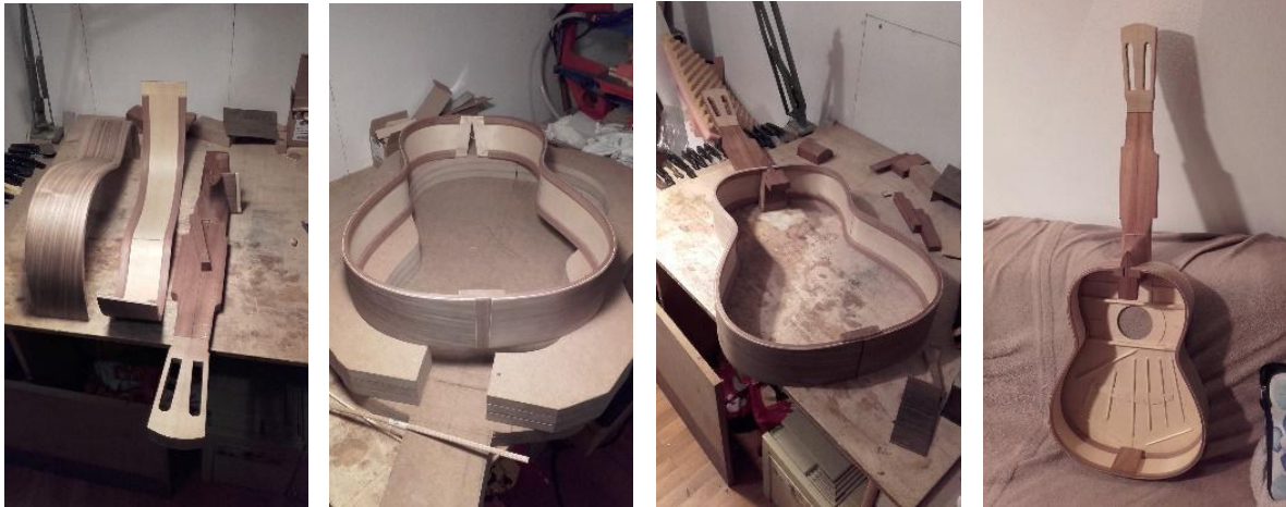
Slika 14. Tradicionalan spoj vrata i tijela
