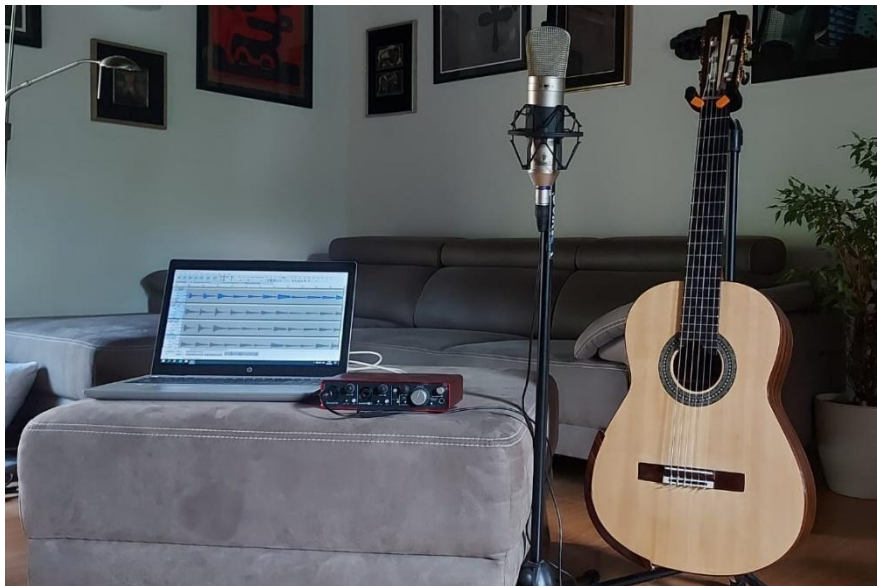
Slika 23. Mjerna oprema korištena za snimanje: prijenosno računalo, audio sučelje Focusrite Scarlett 2i4 i kondenzatorski mikrofonski sustav Behringer B-2 Pro
