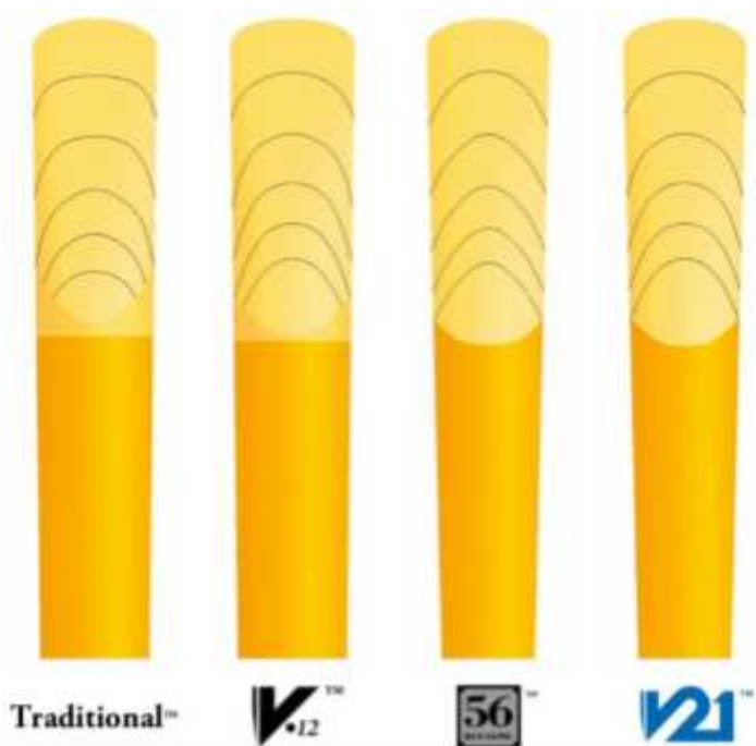
Slika br. 3: Topografski dijagram profila najpopularnijih Vandoren modela jezičaca
