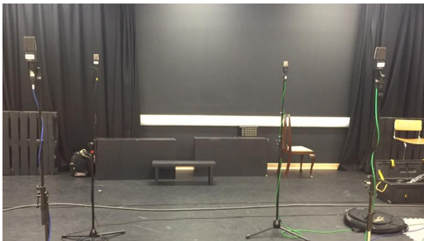
Slika 27. Primjer postave Hamasaki tehnike. 211
