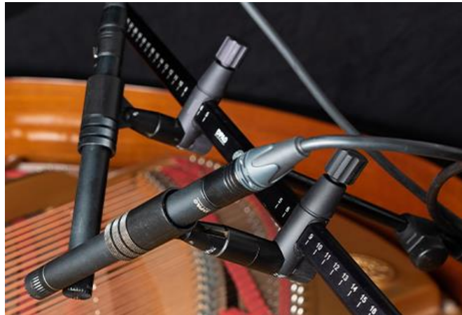
Slika 3. Primjer postave XY-para pod kutom od 90°. 52
