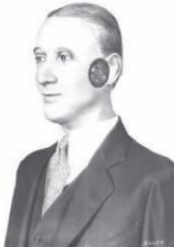
Slika 16. Prikaz prvoga binauralnog mikrofona koji je osmislio i patentirao Harvey Fletcher. 115
