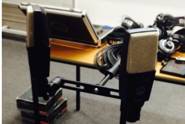
Slika 13. Primjer postave NOS-para. 96
