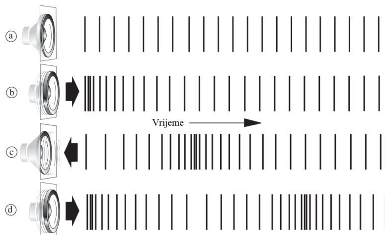
Slika 3: Promjene u tlaku zraka prilikom reproduciranja zvuka iz zvučnika (Izvor: Crich, 2010, str. 12)
