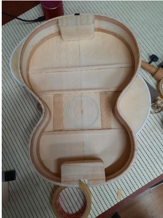
Slika 7: Primjer unutarnje strane glasnjače bez jajeta, sa kutijom oko glasnjače
