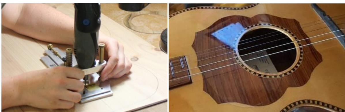
Slika 16: Izrada ležišta za rozetu
