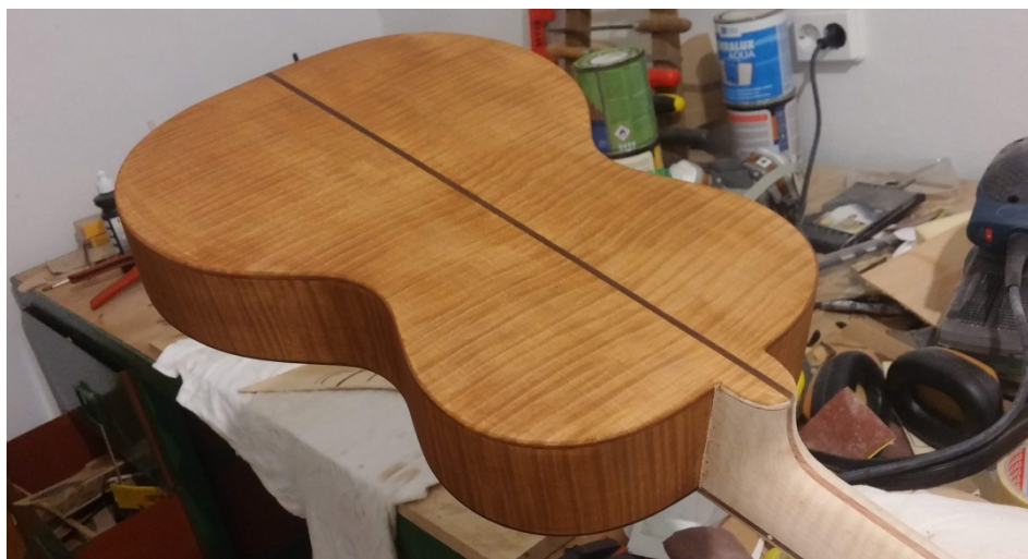
Slika 37: Izgled nanešenog bajca na braču
