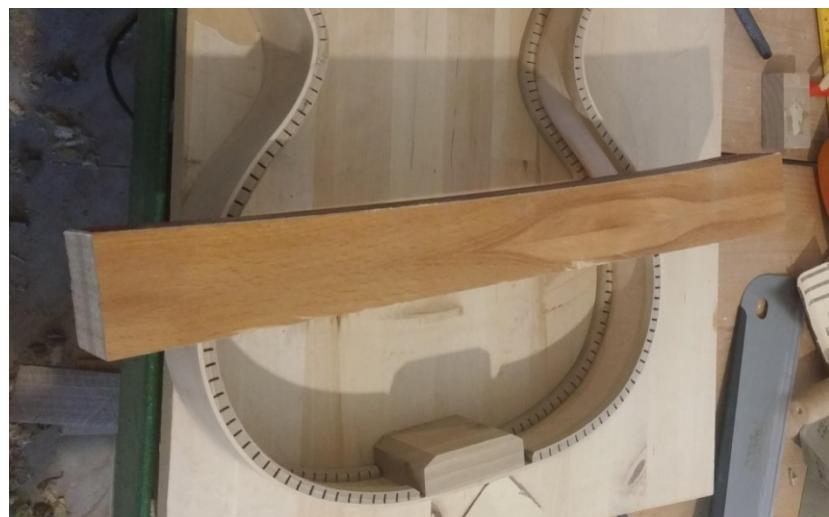
*Slika 28: Drveni blok za brušenje stranica*
