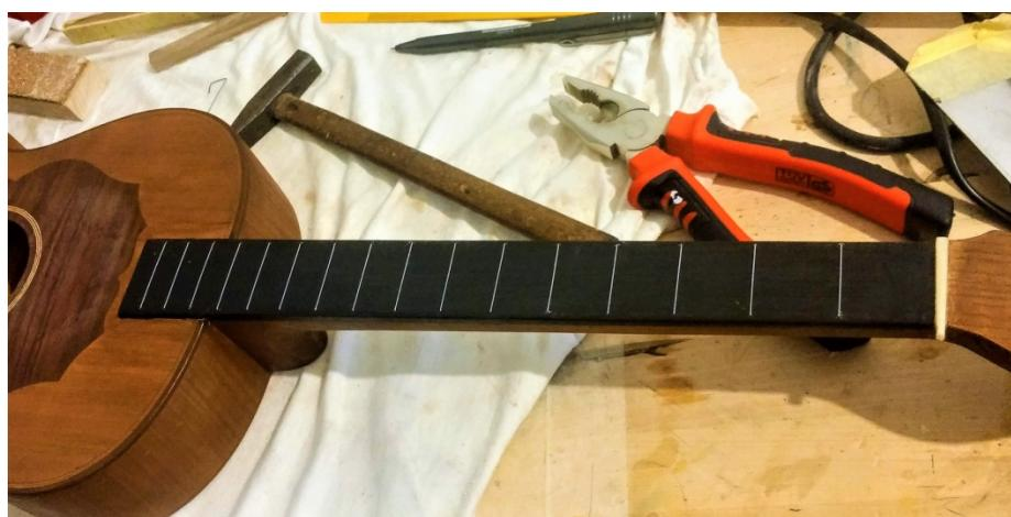
Slika 36: Izgled postavljenih prečnica
