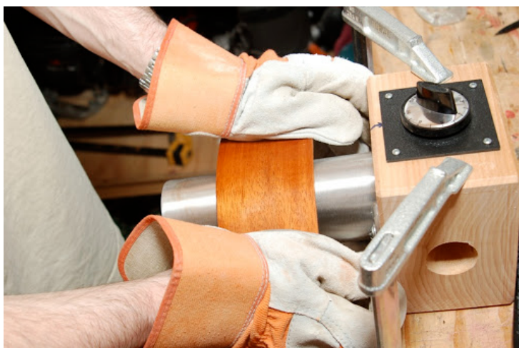
Slika 20: Savijanje stranice pomoću vruće metalne cijevi
