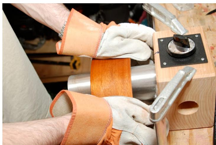
Slika 20: Savijanje stranice pomoću vruće metalne cijevi
