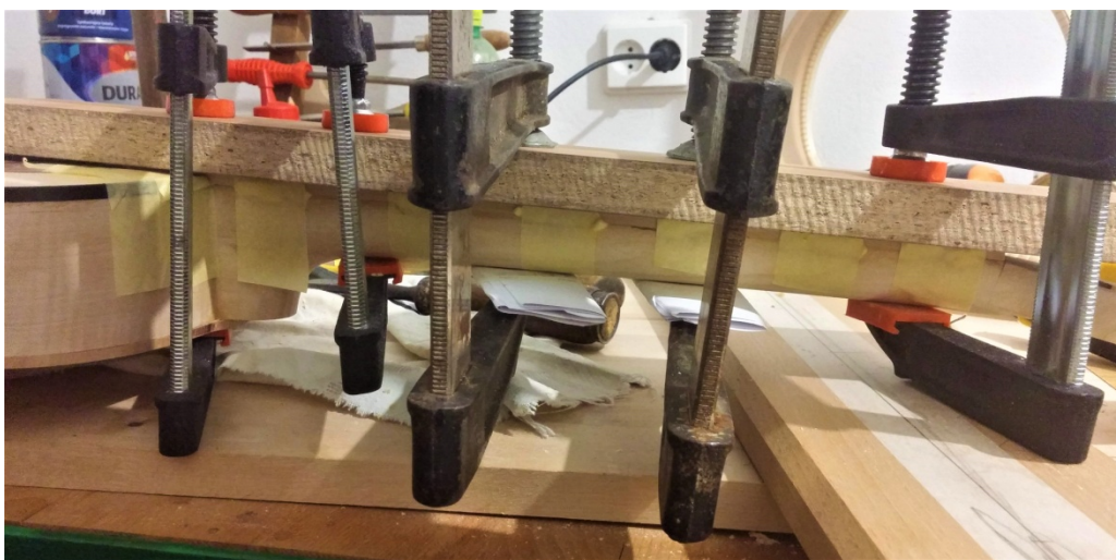
Slika 33: Lijepljenje hvataljke na vrat
