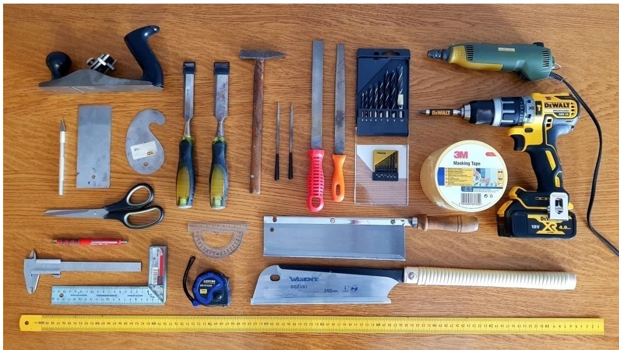
Slika 10: Primjeri ručnog i električnog alata za izradu brača
