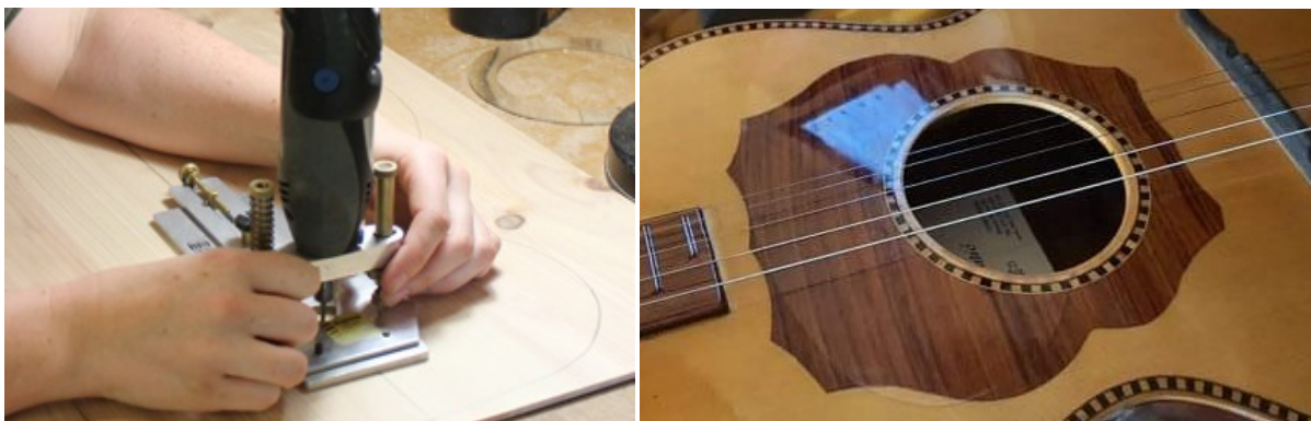
Slika 16: Izrada ležišta za rozetu
