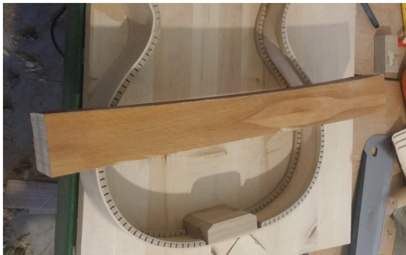
Slika 28: Drveni blok za brušenje stranica
