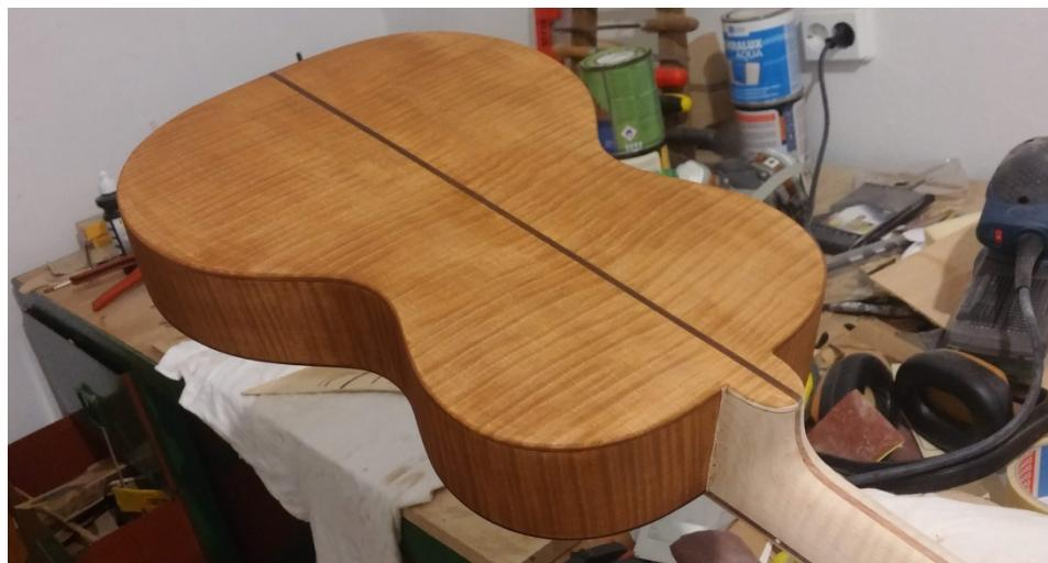
Slika 37: Izgled nanešenog bajca na braču
