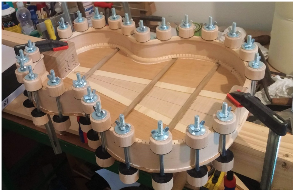
Slika 30: Lijepljenje leđa sa stranicama
