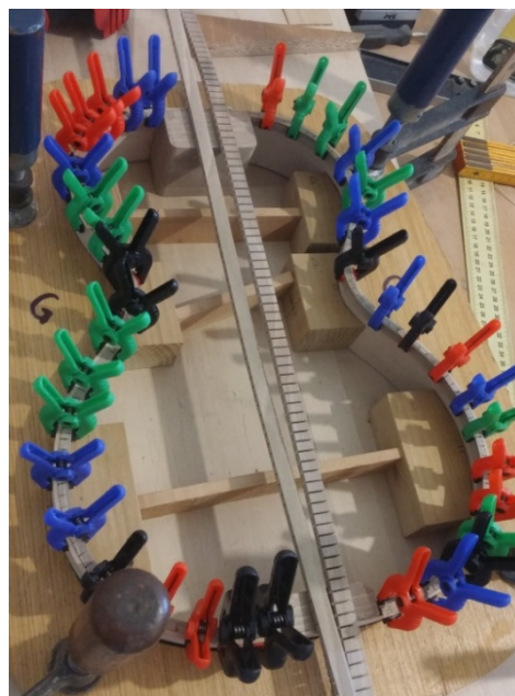
Slika 23: Lijepljenje rubnih letvica
