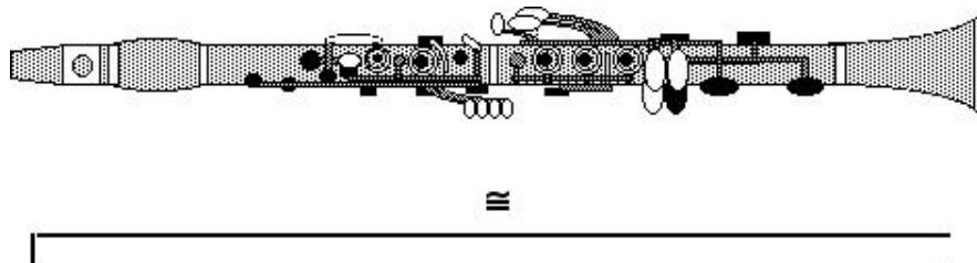
Slika 4.7: Aproksimacija klarineta poluotvorenom cilindričnom cijevi [6]
