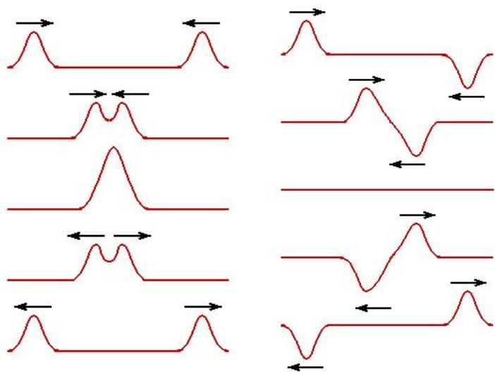
(a) Konstruktivna (zbrajanje) (b) Destruktivna (poništavanje)
