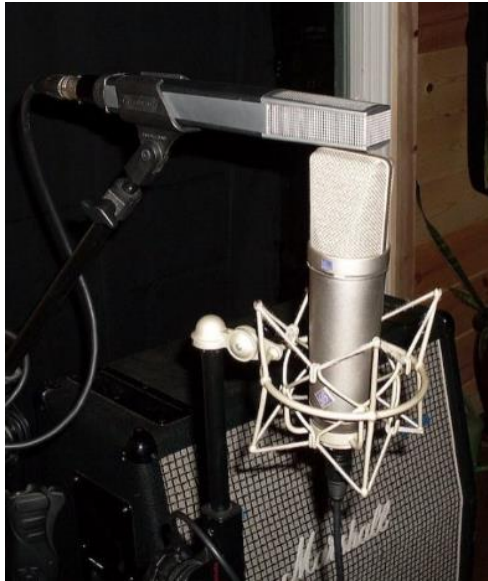
Slika 7. Primjer postave MS-para. 68
