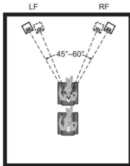
*Slika 15. Primjer stereofone postave zvučnika kojom se osiguravaju optimalni uvjeti slušanja.*<sup>108</sup>
