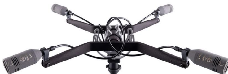
Slika 25. Primjer postave za IRT-tehniku. 209
