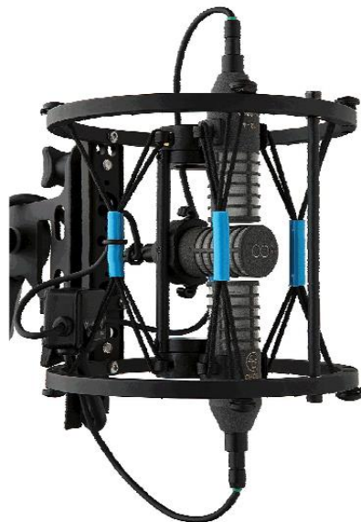
Slika 23. Primjer postave za dvostruku MS-tehniku. 207
