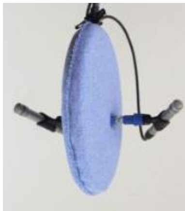
Slika 19. Primjer postave Jecklinova diska. 157
