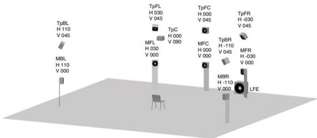
Slika 35. Primjer 11.1 Auro 3D konfiguracije zvučnika.<sup>263</sup>
