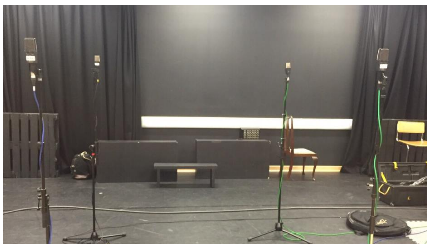
Slika 27. Primjer postave Hamasaki tehnike. 211
