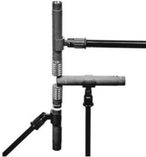
Slika 32. Primjer postave tehnike FOA. 242
