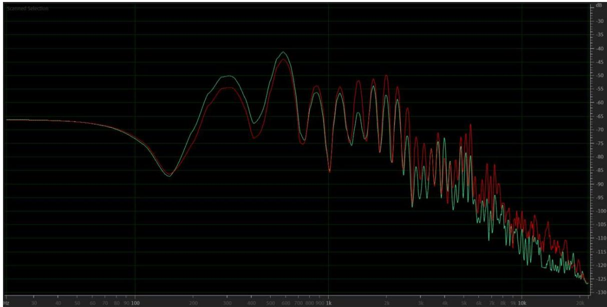
*Slika 19 Četvrta žica na Juzbašićevu bisernici okomit titraj (zeleno), paralelni titraj (crveno)*
