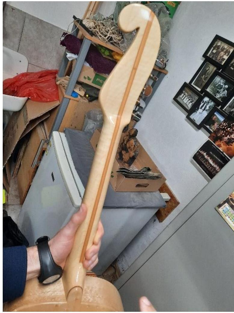
*Slika 3: Primjer brača s vratom iz tri dijela*
