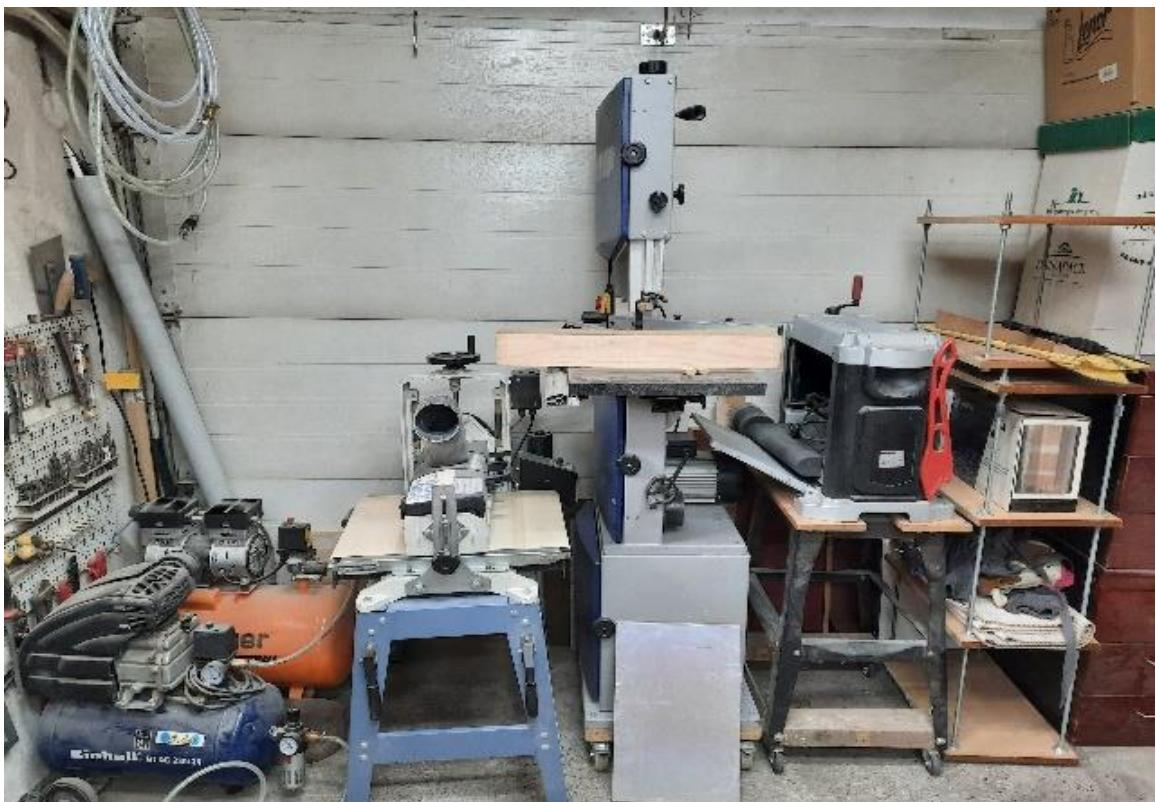
Slika 5: Primjeri strojeva iz radionice Juraja Jurčića. S lijeva na desno: dolje u kutu dva kompresora za lakiranje (plavi i narančasti), cilindrična brusilica (služi za stanjivanje drveta brušenjem), zatim tračna pila bansek (za rezanje drva), te debljača (za fino stanjivanje glasnjače na određenu debljinu)
