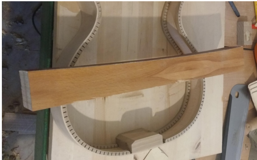
Slika 28: Drveni blok za brušenje stranica
