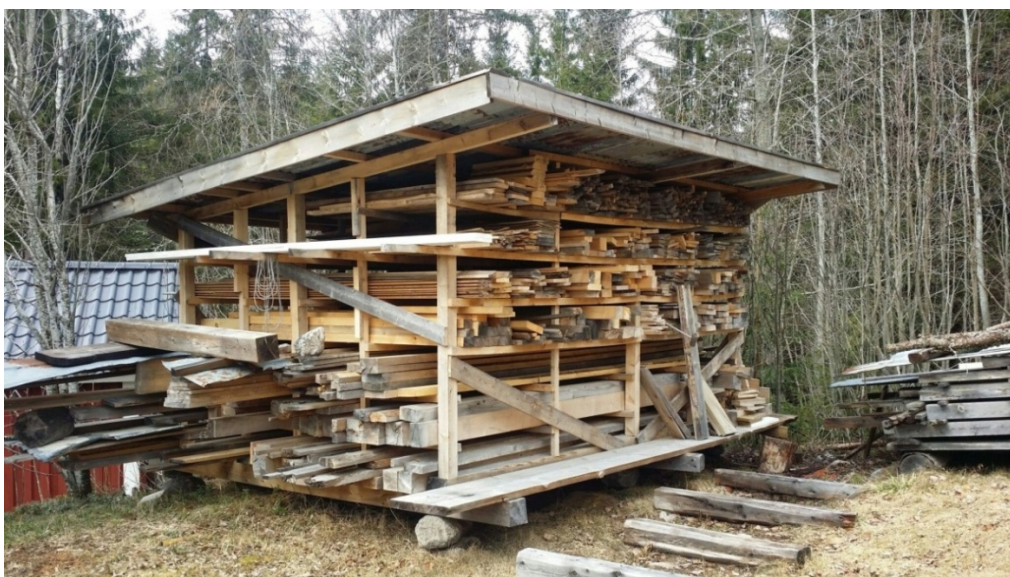
Slika 9: Prikaz sušenja drveta
