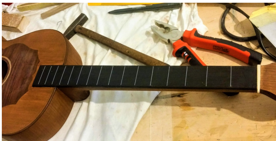
Slika 36: Izgled postavljenih prečnica
