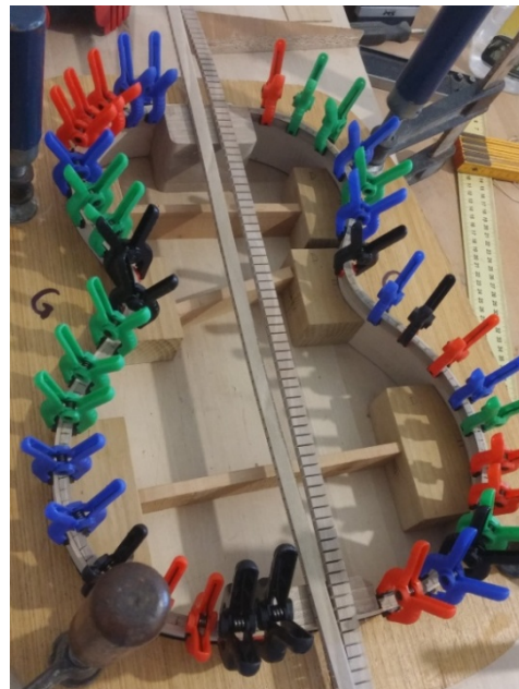
Slika 23: Lijepljenje rubnih letvica
