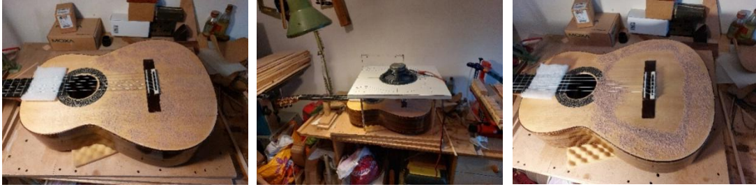
Slika 34. Provjera moda T(1,1) pobudom glasnjače sinusnim signalom frekvencije 191Hz iz zvučnika
