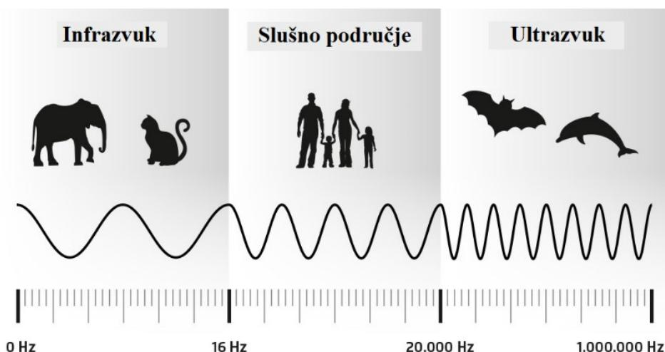
Slika 15: Područje infravezvka, čujnog frekvencijskog područja i ultravezvka prikazanim u Hz
