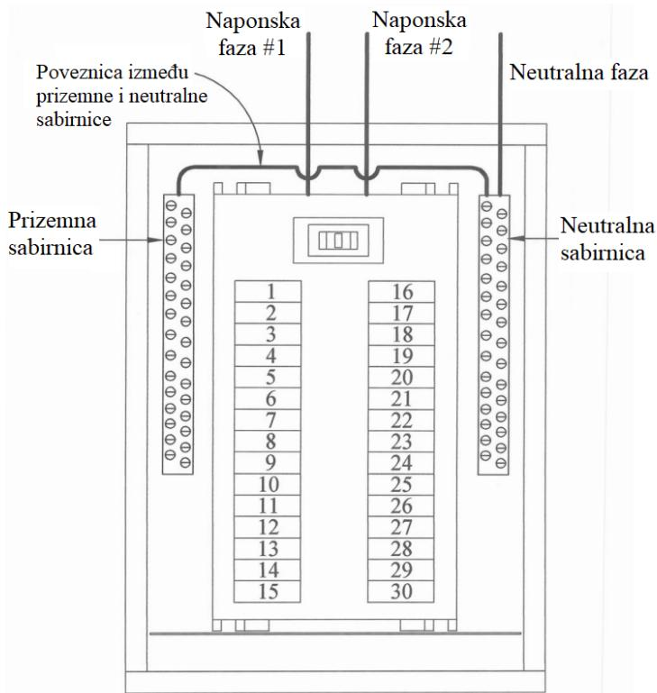
Slika 29: Klasični električni razvodni ormari (Izvor: Gervais, 2011, str. 116)
