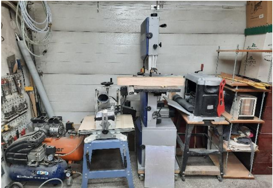
Slika 5: Primjerci strojeva iz radionice Juraja Jurčiča. S lijeva na desno: dolje u kutu dva kompresora za lakiranje (plavi i narančasti), cilindrična brusilica (služi za stanjivanje drveta brušenjem), zatim tračna pila bansek (za rezanje drva), te debljača (za fino stanjivanje glasnjače na određenu debljinu)
