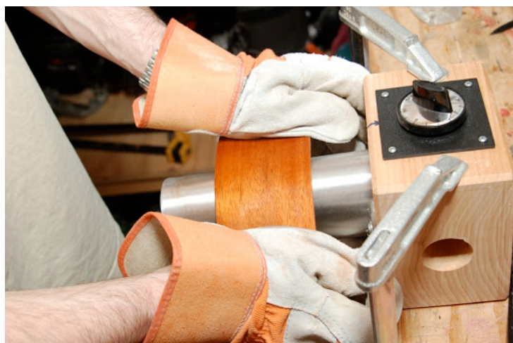
Slika 20: Savijanje stranice pomoću vruće metalne cijevi
