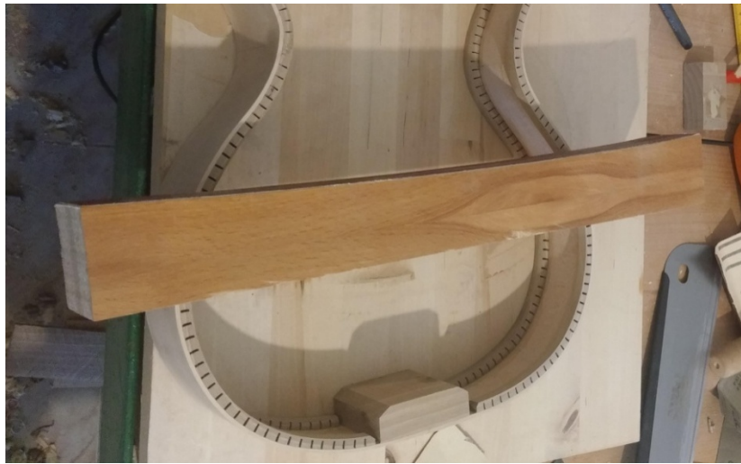
Slika 28: Drveni blok za brušenje stranica
