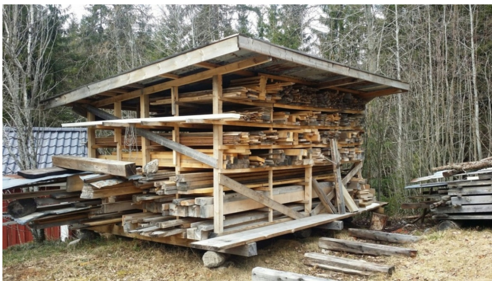
Slika 9: Prikaz sušenja drveta
