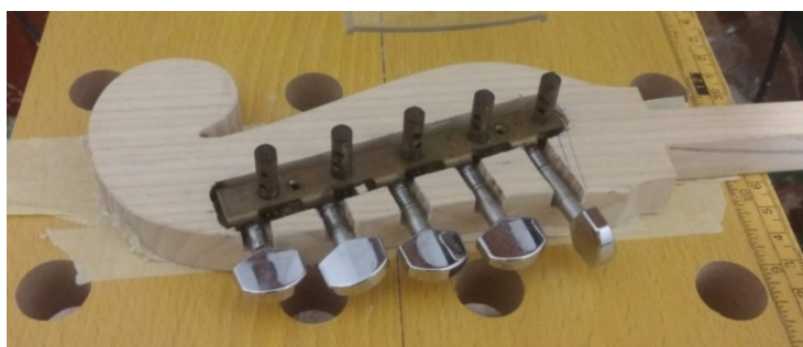
Slika 26: Prikaz mehanizma za žice u sjedištu
