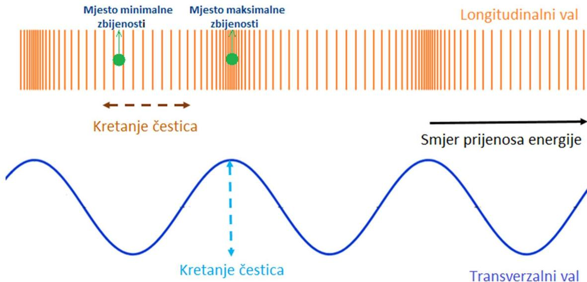
Slika 2: Transverzalni i longitudinalni val<sup>1</sup>
