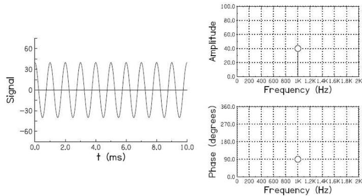
Slika 3: Primjera sinusnih valova (Hartmann, 2013)
